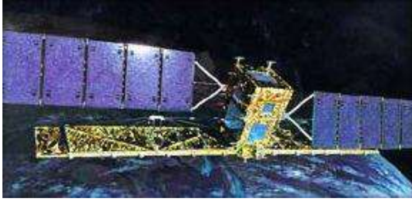
الشكل 2-13 قمر صناعي فعال مع هوائيات اتجاهية
