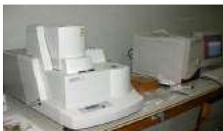
شكل 6-1 جهاز الفصل الكروماتوغرافي (HPLC)
